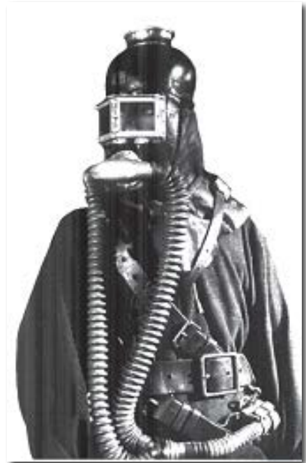
Schlauchatmer mit handbetriebenem Blasebalg Baujahr 1878 (Quelle: Ausbilderleitfaden AT SFSW)
