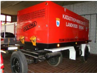
Notstromaggregat, Leistung 15kVA
